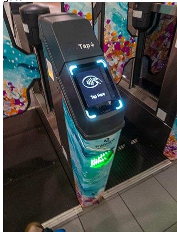
Smart Ticketing fare validator on fare gate.
