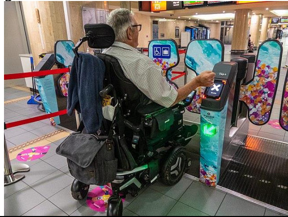
Smart Ticketing fare validator on fare gate.
